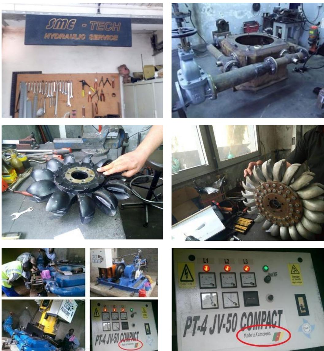
Plusieurs micro-centrales hydroélectriques installées dans la région du Nord-ouest et opérationnelles depuis plus de cinq ans utilisent ces équipements, selon le promoteur. L'entreprise a une capacité de production de dix turbines par an, selon la capacité de la turbine, et est capable de fabriquer des équipements pour des micro centrales allant jusqu'à 200kW.
